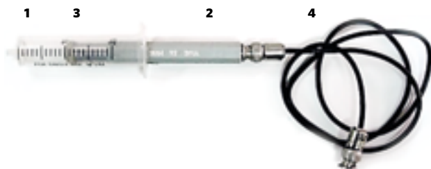
Рис. 2. Вид ультразвукового шприца с использованием стандартных медицинских устройств: 1 — корпус шприца; 2 — излучатель ультразвука ИУТ 0.88-1.03 Ф; 3 — уплотняющее кольцо-манжета; 4 — кабель для соединения излучателя с медицинским генератором ультразвука УЗТ-1.01 Ф
