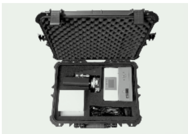
Рис. 7. «БИОТЕСТЕР»: блок пробоподготовки, технологический модуль, оптический микроскоп, автономный термоэлектрический холодильник, размещённый в транспортном чемодане-контейнере
