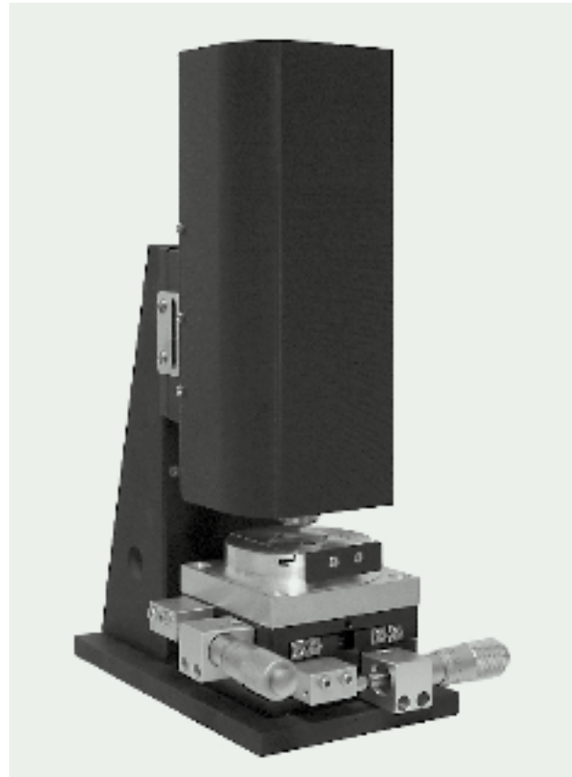
Рис. 5. Оптоэлектронный блок обработки результатов анализа. Микроскоп с высокой разрешающей способностью с установленным в нём биочипом, передающий результаты измерений в компьютер
