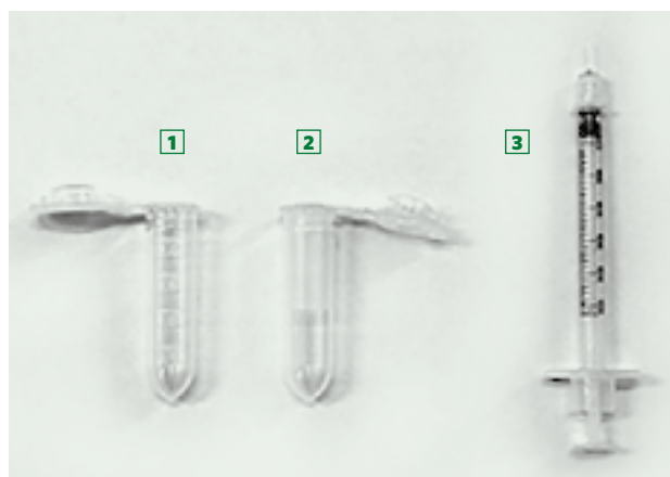
Рис. 1. Набор инструментов для забора биопроб и их загрузки в биочип: 1 — пробирка с антителами и магнитными частицами; 2 — пробирка с пробой (антигенами); 3 — шприц BD U-100, в котором производится смешение и соединение антител с антигенами
